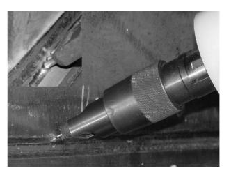
Fig. 4 Pin of UIT-equipment
